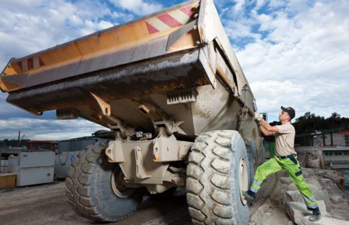
Ein Muldenkipper / Dumper fasst 23 m 3 Ladung.
