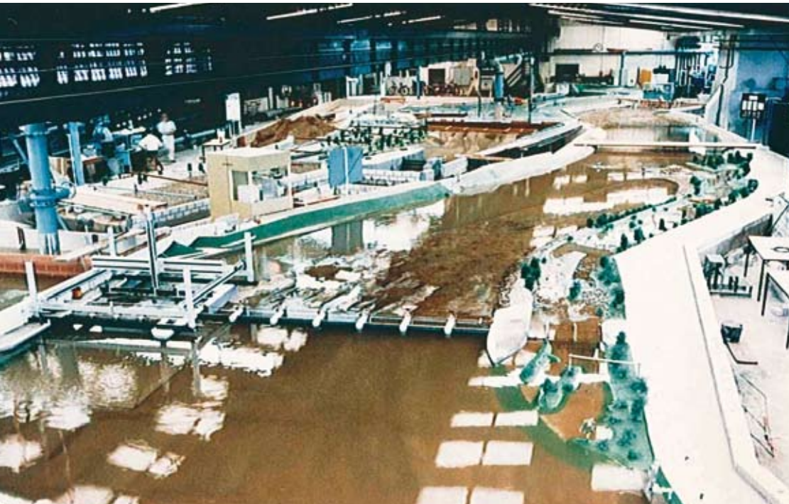
Hydraulisches Modell der Gesamtanlage in der Versuchshalle des Theodor-Rehbock-Laboratoriums in Karlsruhe
